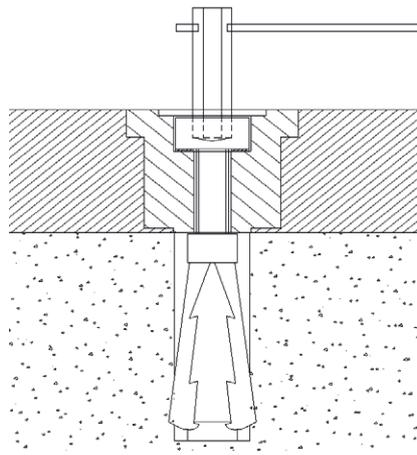
**5.** Setzen Sie den Ankerbolzen ein und ziehen Sie ihn fest an. (Es wird empfohlen, einen Drehmomentschlüssel mit einem Drehmoment von 30 N-m zu verwenden)
