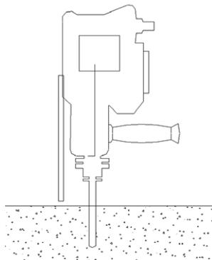
**2.** Bohren Sie ein Loch mit einer Hammerbohrmaschine (empfohlener maximaler Bohrer  $\varnothing 25$  mm, bis zu einer Tiefe von 115 mm für Tresore bis Klasse III und 125 mm für Tresore bis Klasse V)
