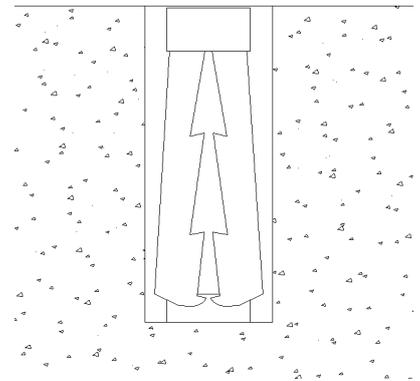
**3.** Reinigen Sie das gebohrte Loch von Staub und setzen Sie eine Ankerhülse (ohne Bolzen) in das Loch.
