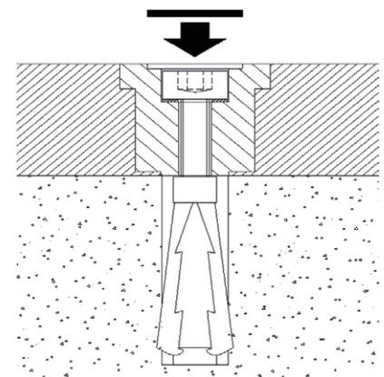
**6.** Setzen Sie den Kunststoffstopfen ein und drücken Sie ihn ein, um den Schraubenkopf und das Buchsenloch abzudecken.
