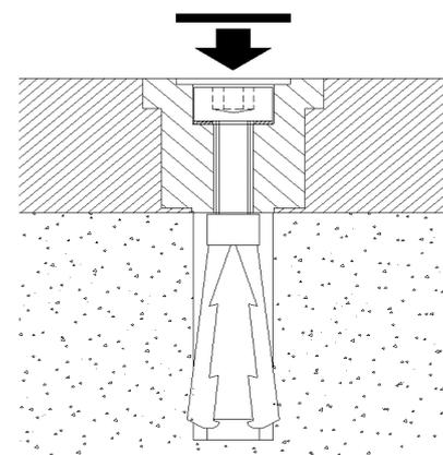
**6.** Setzen Sie den Kunststoffstopfen ein und drücken Sie ihn ein, um den Schraubenkopf und das Buchsenloch abzudecken.
