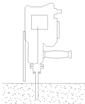
**2.** Bohren Sie ein Loch mit einer Hammerbohrmaschine (empfohlener maximaler Bohrer  $\varnothing$  20 mm, bis zu einer Tiefe von 70 mm).
