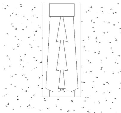
**3.** Reinigen Sie das gebohrte Loch von Staub und setzen Sie eine Ankerhülse (ohne Bolzen) in das Loch.
