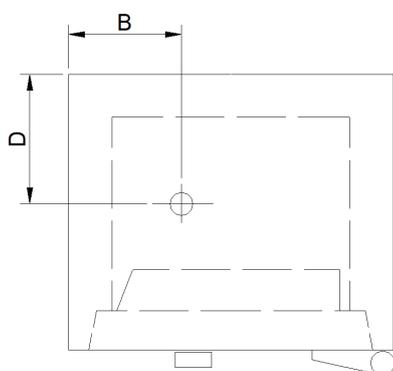
**1.** Markieren Sie die Position für ein Loch auf dem Boden gemäß den vorgegebenen Maßen des Tresors, der verankert werden soll.
