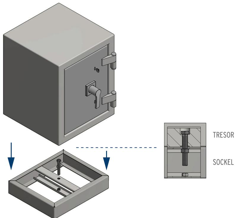
**B** Montage des Tresors an der Rückwand -
