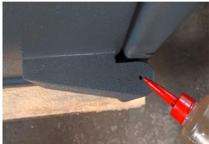
*Schmieren des Scharniers/Zapfens durch die Bohrung auf der Oberseite beider Scharniere*
