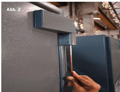
**Ziehen Sie die Gewindestiftschraube an:** Wenn die Türhöhe korrekt eingestellt ist, ziehen Sie die M6-Gewindestiftschraube mit dem Inbusschlüssel Größe 3 fest.
