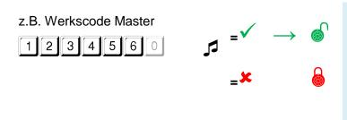
Die Eingabe des Öffnungscodes kann direkt ohne Anwahl o.ä. erfolgen. Der Riegel wird nach Eingabe eines gültigen Codes für ca. 3 Sekunden frei gegeben bzw. zurück gefahren. Öffnen Sie das Wertbehältnis nach der Codeeingabe innerhalb dieses Zeitraumes.
