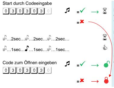
Ist eine Zeitverzögerung programmiert, muss zunächst diese durch Eingabe eines gültigen Öffnungscodes gestartet werden. Durch erneute Eingabe eines beliebigen, gültigen Nutzercodes innerhalb des Öffnungszeitfensters kann dann geöffnet werden. Nutzer 9 kann die Verzögerung nicht starten, dafür aber vor Ablauf der Verzögerungszeit öffnen.
