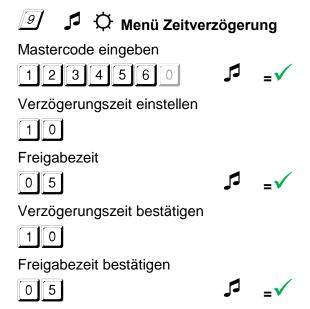
Ein Heraufsetzen der Öffnungsverzögerungszeit kann jederzeit erfolgen. Eine Reduzierung der Öffnungsverzögerungszeit bzw. eine Deaktivierung der Zeitverzögerung ist nur während der Freigabezeit möglich.
