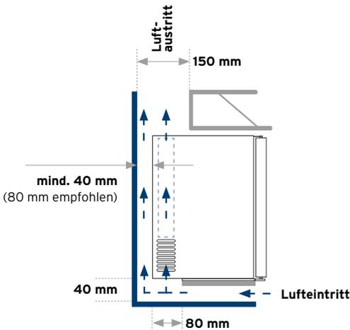
Minibars entziehen dem Innenraum Wärme, um ihn zu kühlen. Diese Wärme geben sie über die Rückseite wieder ab. Daher muss die Luft um die Minibar herum frei zirkulieren können. Hierfür ist es erforderlich, beim Einbau für die Zu- und Abluft **jeweils einen freien Lüftungsquerschnitt von mindestens 200 cm<sup>2</sup>** zu gewährleisten. Generell gilt: **Je besser die warme Abluft von der Minibar weggeleitet wird, umso besser ist ihre Effizienz, d. h., der Energieverbrauch sinkt.**
