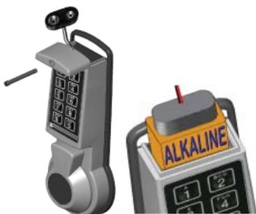
Wenn beim Öffnen eine Reihe von akustischen Signalen ertönen, ist die Batterie fast leer und muss sofort ausgetauscht werden. Verwenden Sie **nur 9V Alkaline Duracell, Duracell Industrial- oder Energizer Batterien.**
